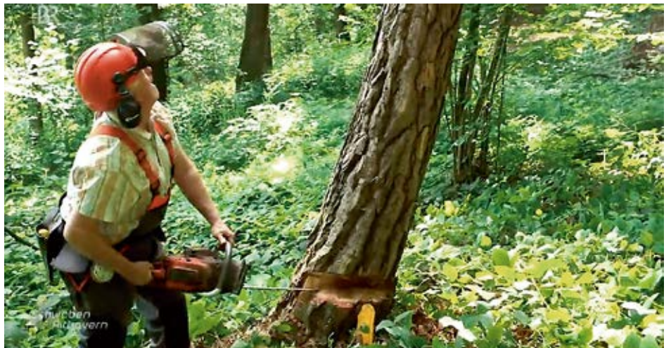
Abb. 7: Zu nah am fallenden Baum! Dieser Fehler ist oft zu beobachten, wie unlängst wieder in einer regionalen Fernsehsendung. In dem Beitrag wird diese riskante Arbeitshandlung als vermeintliches Positivbeispiel für „sichere Profiarbeit“ dargestellt. Quelle: SVLFG
