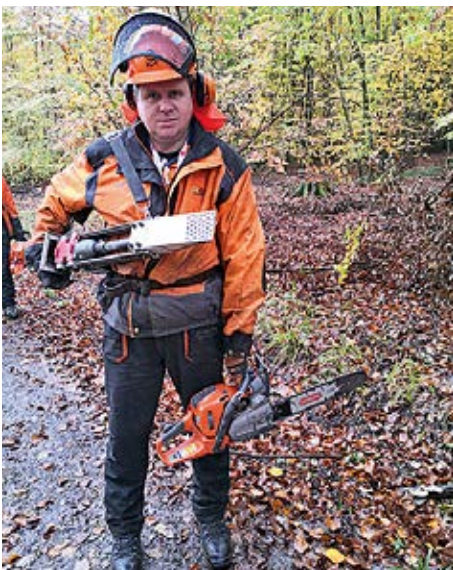
Foto 4: Ein Mitarbeiter der NSW Forst mit funkfern gesteuertem Fällkeil
